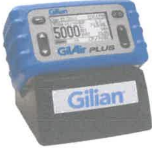
Çizelge 6.2.1. Kişisel Uçucu Organik Bileşik Maruziyeti Ölçüm Sistemi
